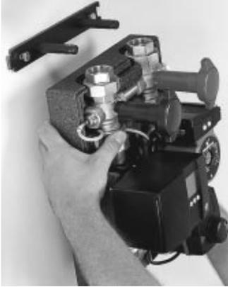
vorbereitet worden. Nach dem Befestigen der Wandhalterung wird die Station samt Dämmschale lediglich eingeklickt. Alle Komponenten sind betriebsfertig verrohrt und verkabelt, so auch die drehzahlgeregelte Umwälzpumpe und der Heizungsregler. Eine Variante hierzu ist die Etagenregelstation ERS. Schnellbefestigungsbolzen reduzieren auch hier den Einbau des Verteilers.
