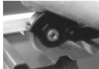
lich, die die Bezeichnung „Super Guard“ trägt. Dieser Schutz entspricht den neuen EU-Sicherheitsempfehlungen für Frässscheiben in Winkelschleifern.
