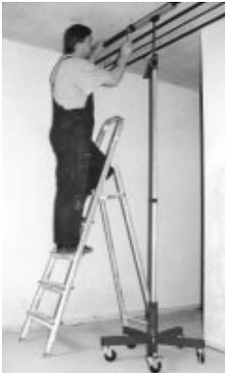
erforderlich. Für das zwischen 1,17 m und 3,0 m stufenlos verstellbare Hilfsgerät gibt es außerdem entsprechend der zu haltenden Teile verschiedene Zubehörteile für das Positionierende, die mit einer Schnellwechselvorrichtung ausgetauscht werden können. Der Teletop ist bis zu 40 kg belastbar und kostet als Normalversion 79,- DM und als Profiversion 119,- DM.
