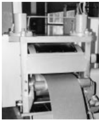
... durch die Prägemaschine zur Strukturierung der Oberfläche ...
