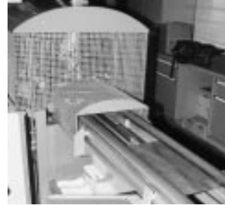
... und in einer Spezialmaschine die ober- und unterseitigen Falze
