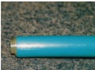
Die Hülse wird bis zum Anschlag in das Rohrende eingeschoben
