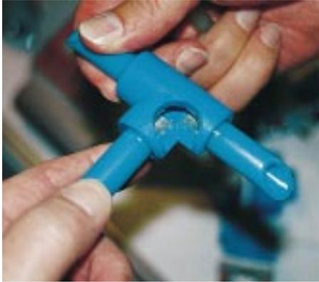
**Im angebohrten T-Stück sind sowohl die Stützhülsen zu erkennen, die sich durch das Erwärmen nicht verändert haben, als auch die homogene Verbindung zwischen Rohr und Fitting**
