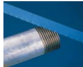
**Als vorbereitende Arbeit für das Eindichten von Gewinden ist auch bei Gewindefäden von Loc-tite 55 das Aufrauen (das natürlich auch mit einem Aufraugerät erfolgen kann)**
