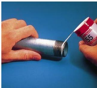
**Wie beim Eindichten mit Hanf auch setzt man den Dichtfaden am Gewindeanfang an . . .**
