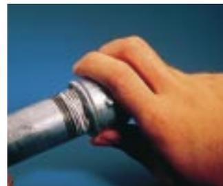
**Wie bei kegeligen Gewindepaarungen üblich, wird der Fitting die ersten Gänge per Hand aufgeschraubt . . .**
