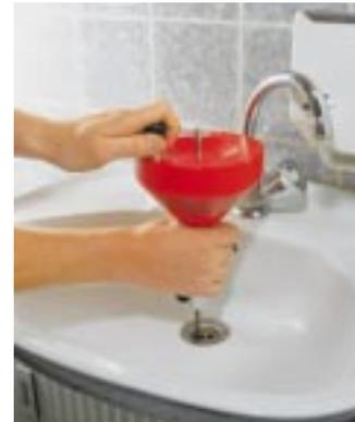
**Rohrreinigungsgeräte mit Spiralen, die von Hand oder elektrisch betrieben werden können, entfernen hartnäckigere Verschmutzungen**
