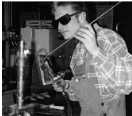
Trinkwasserleitungen aus Kupfer werden ab DN 28 hartgelötet
