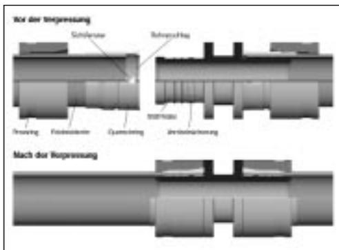
der Fittingkontur von innen in das Rohr ein, sodass eine formschlüssige, metallisch dichtende Pressverbindung entsteht, die ohne O-Ring auskommt. In Kombination mit einem Akku-Presswerkzeug bietet die Verbindung die Vorteile von Pressverbindungen ohne die Nachteile des Dichtringes. Das umfangreiche Formteilprogramm umfasst die Rohrabmessungen von 15 bis 54 mm und ist für gezogene und geschweißte Edelstahlrohre lieferbar.
