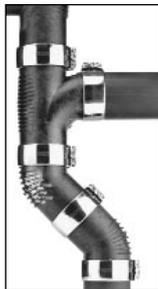
Auch für diese Dimension sind alle mit an den Aufprallzonen des abfließenden Wassers angeordneten Schwingungsdämpfern ausgestatteten Formstücke erhältlich. Für die sichere Verbindung von Rohr und Formstück wird ein Spannverbinder angeboten; ist Längskraftschlüssigkeit gefordert, stehen Elektromuffen zur Verfügung.
