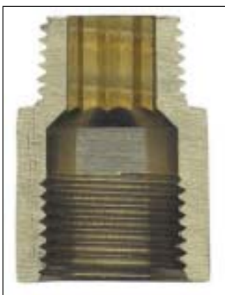
Die aufgeschnittene Anschlussverlängerung aus Rotguss zeigt deutlich das zylindrische Innen- und das kegelig verlaufende Außengewinde
