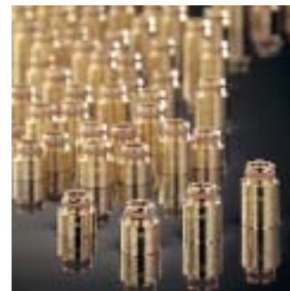
Verlängerungen aus bleiarmedem Pressmessing mit selbstdichtendem Gewinde stellt z. B. Seppelfricke in den Nennweiten DN 15, 20, 25 und 30 mm her
