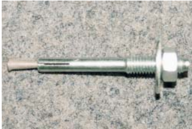
Der Dübel 6 L mit Unterlegscheibe und Sechskantmutter M8 sowie dem fest vormontierten Konusschlagbolzen im geschlitzten Dübelschaft
