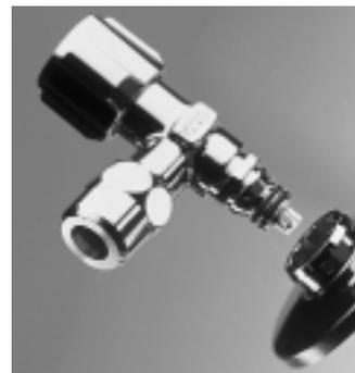
Rohrbauphase eingeschraubt wird, wenn der Arbeitsbereich noch gut zugänglich ist. Nach Abschluss der Fliesenarbeiten braucht der Installateur das Quick-Eckventil nur noch in den Adapter zu stecken. Dabei umschließt der Sicherungsring des Adapters eine spezielle Nut des Eckventils und stellt eine spannungsfreie, unlösbare Verbindung her.
