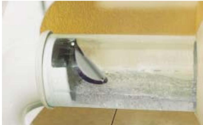
**Die Klappe öffnet sich durch den Spülwasserdruck und schließt sich automatisch durch die eingebaute Edelstahlfeder**
