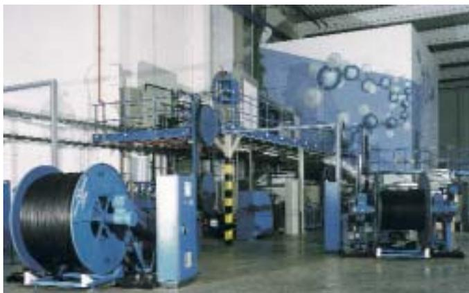
In der Vernetzungsanlage werden die nebeneinander liegenden Molekülketten miteinander verknüpft. Das Rohr wird dadurch unter anderem warmwassertauglich [1]
