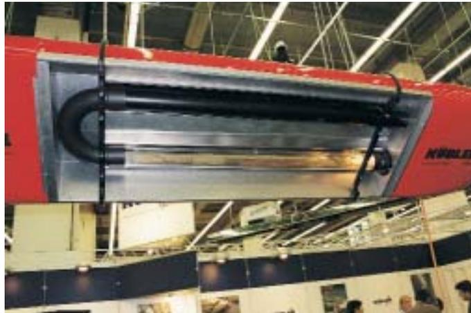
**Das Vorführmodell auf der ISH zeigte es eindrucksvoll: Die Flamme brennt in das Rohr, die Verbrennungsgase heizen das Strahlungsrohr auf**
