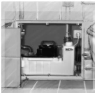
ziell für den Einsatz in einer Vorwandinstallation konzipiert und eignet sich zum Anschluss eines wandhängenden WCs mit einem 9-Liter-Spülkasten. Zusätzlich können eine Dusche, ein Waschtisch und ein Bidet über die Kleinhebeanlage entwässert werden. Dabei sind Transportwege bis zu 56 Meter (bei einer Druckleitung von 36 mm lichter Weite) und eine Förderhöhe von 4 Meter möglich. Ein integrierter Alarmgeber meldet Störungen so rechtzeitig, dass Schäden an der Pumpe vermieden werden.
