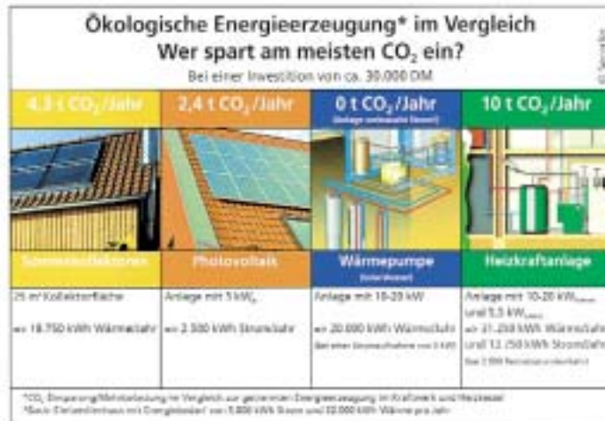
Die Kraft-Wärmekopplung ermöglicht von allen alternativen Beheizungsarten die effektivste CO 2 -Reduzierung [1]
