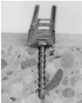
dem Beton hochbelastbar ist. Ferner wird eine Feuerwiderstandsdauer von F 120 erreicht. An dem so erstellten und bauaufsichtlich zugelassenem Befestigungspunkt können also auch Gasleitungen mit nicht längskraftschlüssigen Rohrverbindungen befestigt werden.
