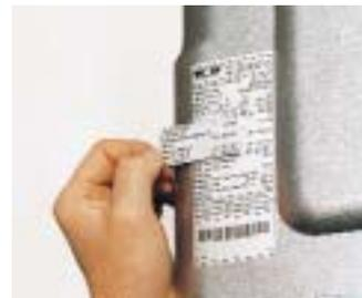
**Die Leistungsanpassung auf dem Typenschild wird korrigiert. Aufkleber gehören zum Umrüst-Set**
