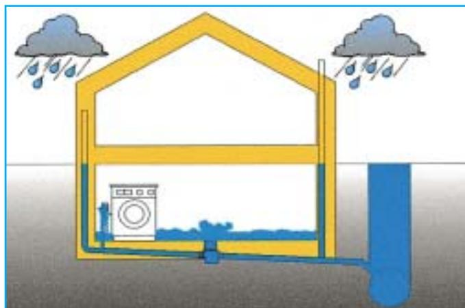
**Ist bei starken Regenfällen der Kanal voll, steigt das Wasser in allen angeschlossenen Rohren gleichermaßen an**
