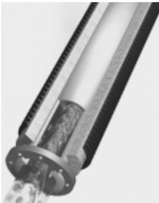
bestehen aus einem nahtlos extrudierten, gewellten Mantelrohr aus schlagfestem, zähelastischen Polypropylen. Diese leicht verschweißbare Außenhaut schützt die innenliegende Dämmung aus PE-X-Material und die medienführende Leitung aus vernetztem Polyethylen.
