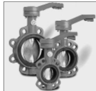
ter Klappenhals. Eine Verwendung als Endarmatur bei einseitigem Abflanschen ist möglich. Die Armatur ist für den Anschluss an Flanschen entsprechend PN 6, 10, 16 und ANSI 150 geeignet. Entsprechend internationalen Normen ist die Baulänge übereinstimmend mit DIN EN 558-1 Grundreihe 20 (ISO 5752 Serie 20), der Kopfflansch entspricht ISO 5211.
