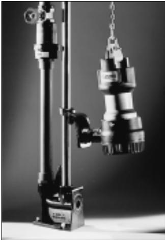
sorgen für eine schnelle Installation auch in engen Schächten, da das Verbindungsstück zwischen Pumpe und Gleitrohr stark verkürzt wurde. Je nach Nennweite des Druckabgangs ist entweder das GR 40 (1½) oder das GR 50 (2) geeignet.
