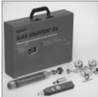
Kalibrierstück für den Sensor, ein Verbindungsschlauch, ein 1/2"-Leitungsanschluss sowie ein Sortimokoffer.
