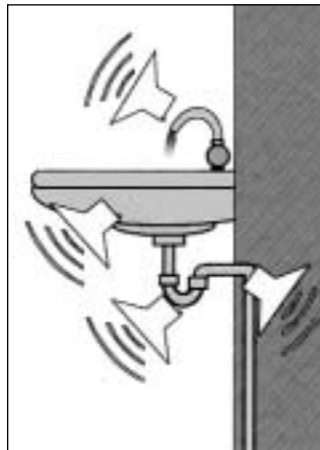
Fließt Wasser, entsteht Schall an zahlreichen Stellen eines Waschtisches
