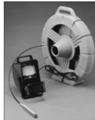
tionssenders am Kamerakopf exakt möglich. Die gesamte Ausrüstung – mit einem 5-Zoll-s/w-Monitor – wiegt rund 8 kg.
