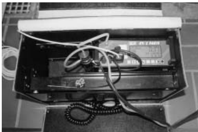
Abgasanalysegeräte nehmen die Messwerte auf und rechnen den Abgasverlust und den CO-Anteil aus
