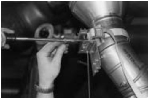
Mit einer Hilfsvorrichtung wird die Sonde für die Dauer der Messung im Kernstrom fixiert
