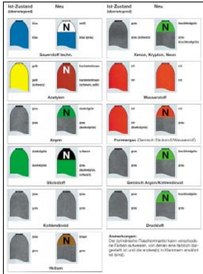
Die alten und neuen, jetzt europaweit gleichen Kennfarben für technische Gase [2]
