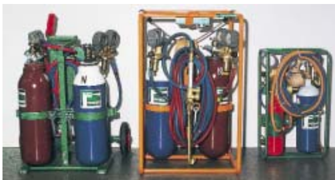
Nur Gasflaschen in z. B. Lötrucksäcken dürfen mit angeschlossenen Druckminderern transportiert werden [3]
