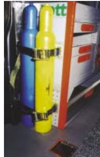
In Kraftfahrzeugen müssen die Flaschen gegen Umfallen gesichert und der Wagen belüftet werden [4]
