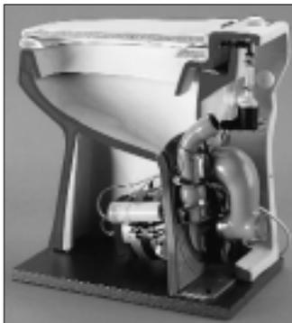
aus und wird – ohne Spülkasten – direkt an die Wasserleitung angeschlossen. Die Fäkalien werden nach Verflüssigung durch ein Förderrohr mit 32 mm Durchmesser abtransportiert. Das im WC eingebaute Fördersystem kann die Abwässer bis zu 40 m weit oder bis zu 4 m hoch pumpen. Er-
