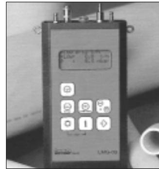
montiert und die zu überprüfen- de Leitung über das LMG-03 mit Gas befüllt. Nach Druckausgleich erfasst das Gerät kleinste Gasmengen, die zum Ausgleich von Leckgasmengen in die zu prüfende Leitung nachströmen müssen. Diese werden angezeigt und gespeichert.
