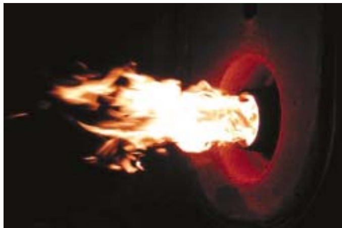
Eine turbulente Flamme ist ein sicheres Indiz dafür, dass es für einen Düsenwechsel Zeit wird
