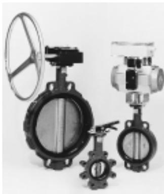
sind sie für den Nennweitenbereich von DN 50 bis DN 300. Die Gehäuse sind in Ringform oder in einer Anflanschgehäuse-Ausführung lieferbar. Als Gehäuseauskleidung stehen EPDM und NBR zur Verfügung. Die Klappenscheibe ist aus Edelstahl oder Aluminiumbronzefertigt. Eine Betätigung der Armatur erfolgt wahlweise manuell per Handhebel,
