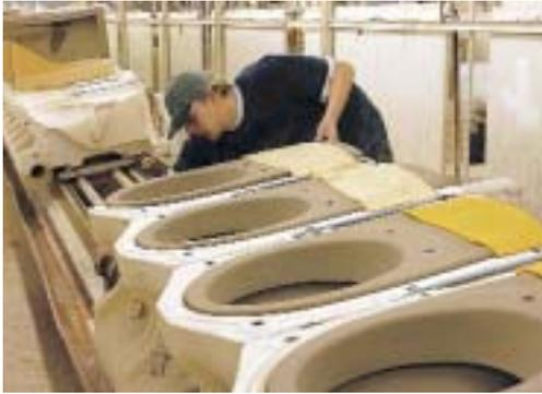
**Zwei Stunden nach der Scherbenbildung kann die Form entfernt werden**
