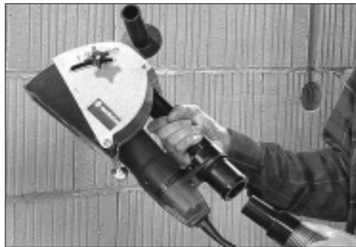
1400 Watt. Durch vier mitgelieferte Distanzringe lässt sie sich auf Fräsbreiten von 10, 17, 23 und 30 mm einstellen. Die Tiefe der Nut ist bis 30 mm stufenlos justierbar. Die Absaugvorrichtung soll ein sauberes Arbeiten ermöglichen. Eine Rolle unterhalb des Motorgehäuses stellt die exakte Führung der Maschine sicher. Und das, nach
