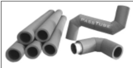
trägliche Dämmen der Leitungen. Zudem ist eine gleichmäßige Dämmstärke an allen Punkten der Leitung gewährleistet. Mittels Verbindungsmuffen werden die Rohre zusammengesteckt und an den Stoßstellen mit einem speziellen Klebeband fixiert. Die Befestigung erfolgt mit handelsüblichen Rohrschellen. Geliefert werden die Rohre in Stangen von zwei Meter Länge. Formstücke, wie 45°- oder 90°-Bögen stehen mit dem Lieferprogramm auch zur Verfügung.
