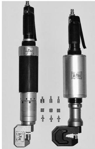
feinblechen bis zu einer Gesamtlechdicke von 3 mm. Drei Baugrößen mit Presskräften bis zu 35 kN sind lieferbar. Das Zangengewicht liegt zwischen 1,8 und 3,2 kg. Die Zangen werden mit Druckluft betrieben. Eine Bestückung der Clinchzangen mit unterschiedlichen
