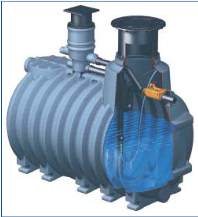
Besonders wichtig im Tank ist der beruhigte Einlauf, um die Sedimentschicht zu schonen
