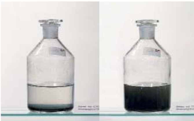
So etwas darf es nicht mehr geben: Wasserprobe aus einer „abgestopften“ Leitung nach Ruhezeit (l.) und frisch geschüttelt (r.)
