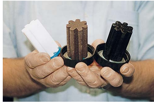
Ölfilter im Vergleich: Fabrikneu (l.), mit schwefelarmen Heizöl (m.) oder mit herkömmlichen Heizöl betrieben
