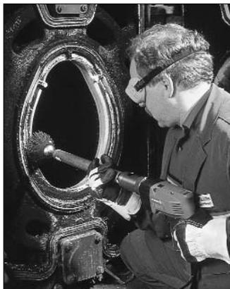
Im Lieferumfang enthalten sind neben einer Zweigang-Handbohrmaschine auch drei Führungsrohre und Spindeln mit einer Länge von 400 mm sowie verschiedene Glocken- und Federbürsten.
