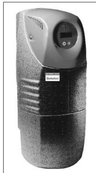
schutz auf der Basis der Bio-mineralisierung. Ein spezielles Katalysator-Granulat, durch welches das Wasser strömt, wandelt die im Wasser enthaltenen Calcium-Ionen zu winzigen Kalkkristallen um. An der Wasseroberfläche kristallisiert der Kalk und wird schließlich mit dem Wasser ausgespült. Das Verfahren wurde nach Firmenangaben vom DVGW im Langzeitversuch getestet und diesem ein Wirkungsgrad von über 98 % bescheinigt.
