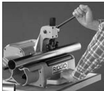
Messvorrichtung ermöglicht das Abmessen von Rohren und ein verstellbarer Schneidguthalter nimmt verschiedene Rohrdurchmesser auf. Neben einen als Zubehör erhältlichen Innengrattentferner bietet Ridge Tool weiteres Zubehör zum schneiden und entgraten von Kupferrohren an.
