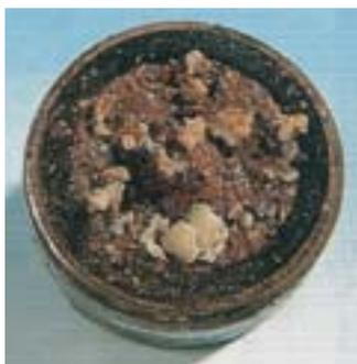
**... dann wird ein Luftsprudler an der Entnahmemarmatur schnell zum Schmutzfanggitter**
