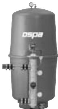
Der Filterkessel ist aus korrosionsbeständigem Polyester gefertigt. Geliefert werden die Anlagen mit einer Rotguss-Filterpumpe mit großdimensioniertem Edelstahl-Vorsiebtropf und Edelstahl-Siebkorb. Sie sind sowohl in voll- als auch halb-automatischer Ausführung erhältlich. Die vollautomatischen Ausführungen sind mit druckwasserbetätigtem Hydro-Umsteuerventil für die Filterspülung ausgestattet, das bei Wasserdruckabfall, wie z. B. bei Stromausfall, selbsttätig schließt.
