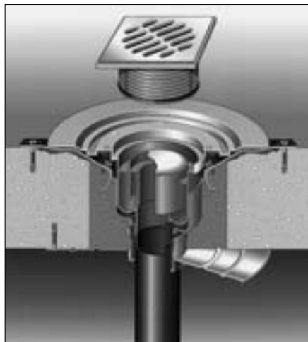
Brandsichere Kunststoff-Bodenabläufe sichern sich wenn es brennt durch eine Quellmasse
