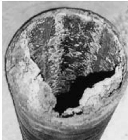
**Ist zu viel Fett im Abwasser, können die Rohre verstopfen oder durch Korrosion beschädigt werden**
