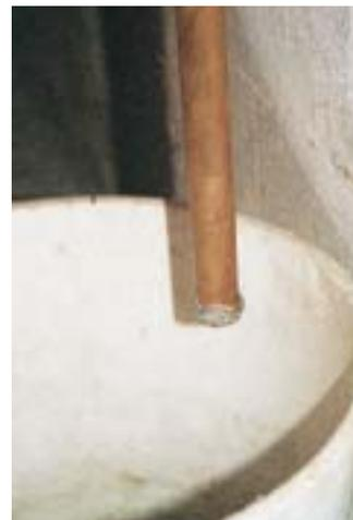
**Auch an den Enden der Tropfwasserleitungen von Sicherheitsventilen lassen die Erdalkalielemente grüßen**
