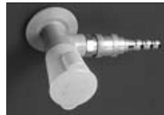
liche und gleichzeitig sichere Verbindung zwischen Scheibenhahn und Gasgerät. Die mit einer Anschlusskupplung mit Stecknippel ausgestatteten Armaturen sollen das Verbinden und Trennen der Schlauchleitung von der Entnahmestelle erleichtern. Der Betriebszustand der Gasarmatur ist auf Grund des Zweiflügelgriffes selbst aus einer gewissen Entfernung zu erkennen. Eine integrierte Sicherheitssperre verhindert
