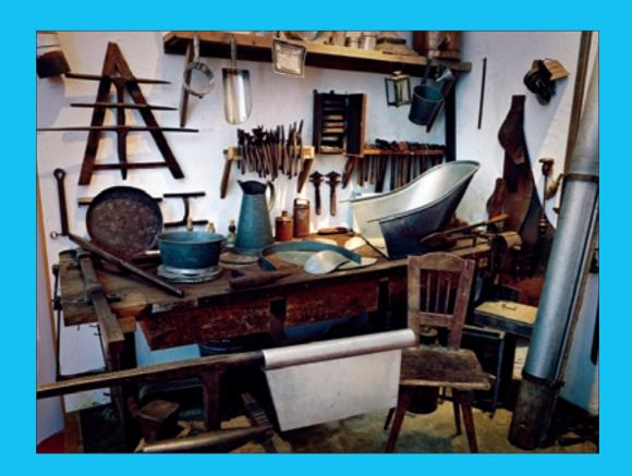
Die Werkzeuge des Weißblechners sind um 1910 noch nahezu die gleichen wie 500 Jahre zuvor. Allein die Wulstmaschine auf dem Holzbock unter dem Fenster kündigt eine Mechanisierung des Berufes an. Hiermit wurden unter anderem die abschließenden Verstärkungswülste der Badewannen und der Dachrinnen geformt. Dachrinnen wurden, entsprechend den Arbeitslängen der Maschinen, in Einmeterstücken hergestellt und auf dem Rinnenholz aufgespannt verlötet.
