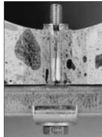
Platzierung von Befestigungspunkten. Nach Angaben von Fischer muss er nicht mittig in die Hohlraumachse gesetzt, sondern kann bis zu einem minimalen Abstand von 50 mm an die Spannstähle herangesetzt werden. Der Anker wird in den drei Größen M 6, M 8 und M 10 galvanisch verzinkt oder – für Spezialanwendun-
