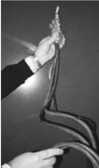
Öl-Ansaugkombinationen mit Saug- und Messleitung sind mit Rückflussverhinderer und Schnellverschlussventil ausgerüstet
